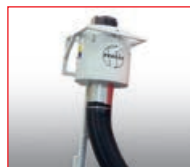
Absaugung des Ölnebels und der Kühlflüssigkeit
